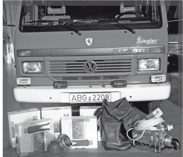
Beschafft wurden: HOCHWASSERSCHUTZPUMPE SPECHTENHAUSER, MINI-CHIEMSEE B 1000 mit einem Korndurchlass von 70 mm, 6 Wathosen mit S3 Sicherheitsschuhwerk sowie ein Keller-saugkorb.
